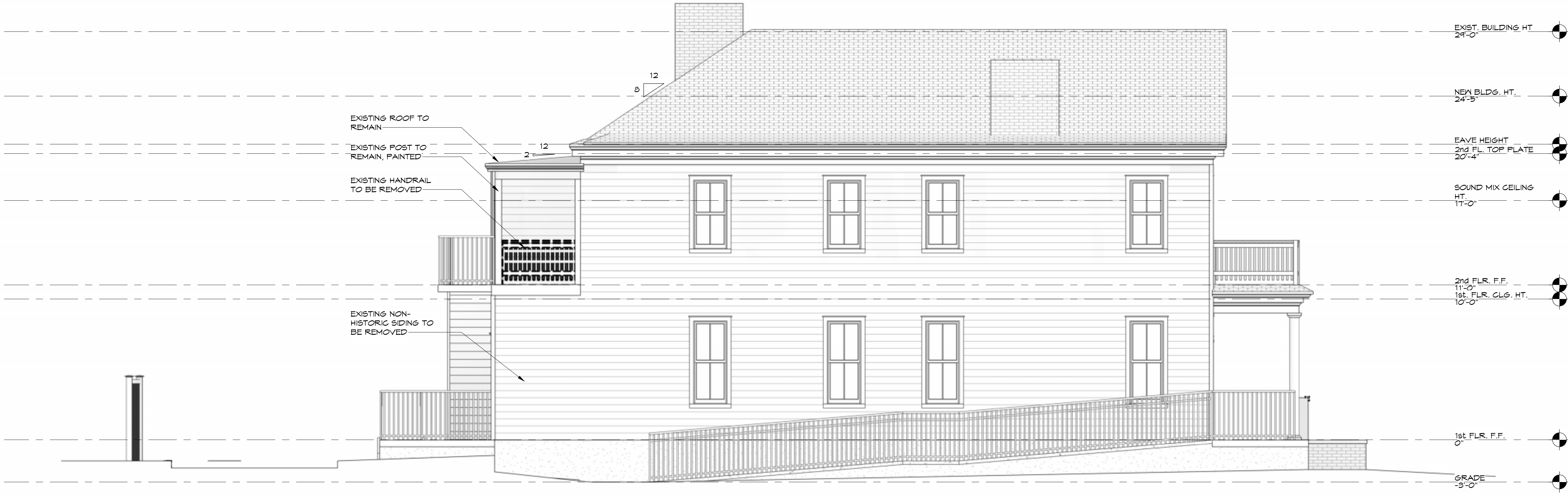
2 A3.4 WEST ELEVATION - EXISTING SCALE: 1/4" = 1'-0"
